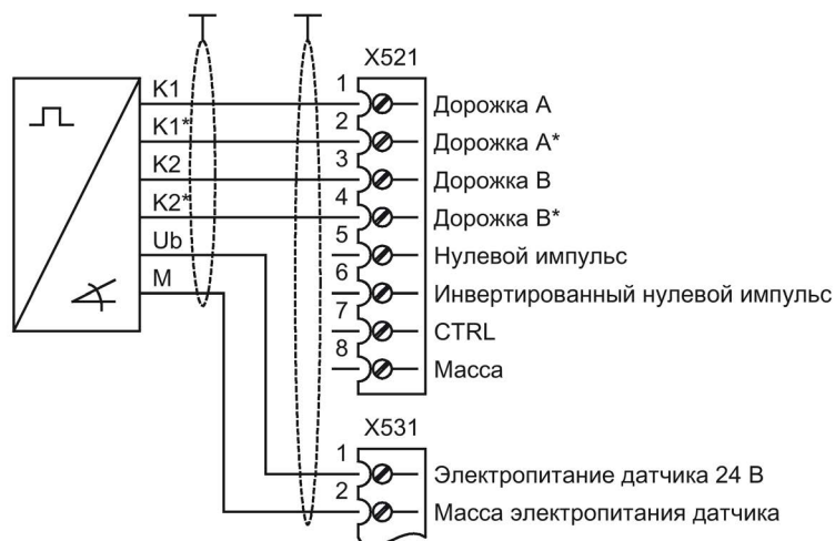
Рисунок 9-26 Пример подключения 1: Датчик НТЛ, двухполюсный, без нулевой метки
